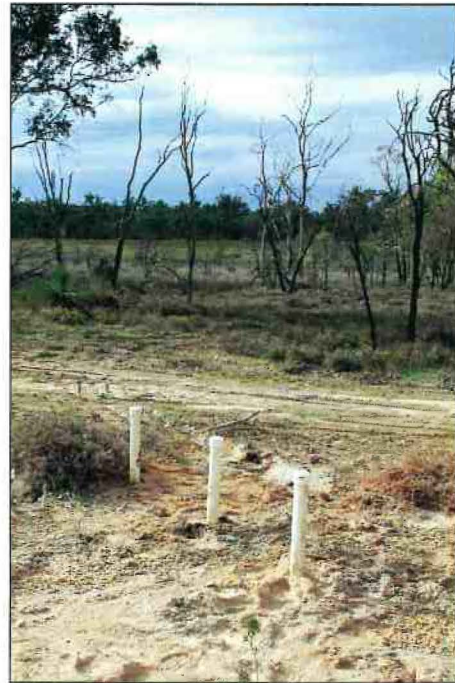
Figure 7 Piezometer nest Drummond NR.
